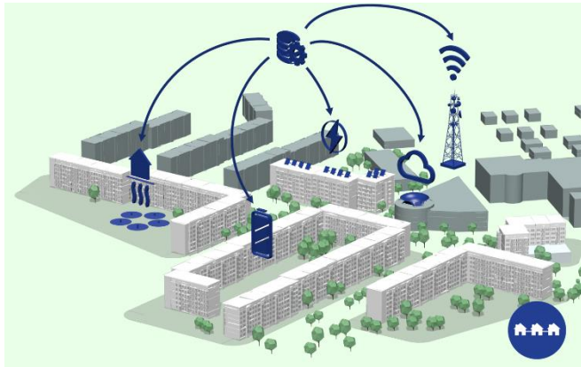
Abb. 1 Im Verbundprojekt smoodACT wurde ein Gebäude- und Quartiers-Energiemanagementsystem konzipiert, entwickelt und getestet.
